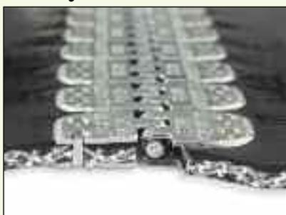
Скобы проникают между волокнами каркаса, не повреждая их. С помощью молотка скобы проходят сквозь ленту, после чего крестообразно заклепываются, что предотвращает их расклепывание при натяжении ленты.
